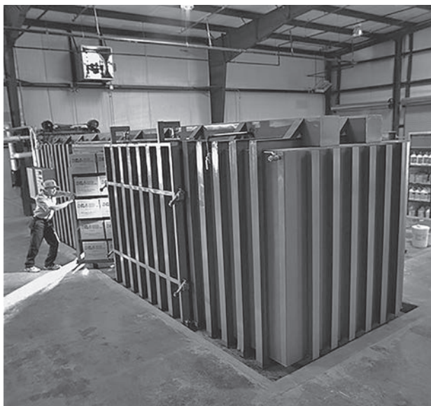
図 1 BELFOR 社の冷凍真空乾燥室 (Belfor ウェブページより) https://www.belfor.com/en/us/recovery-services/document-restoration
